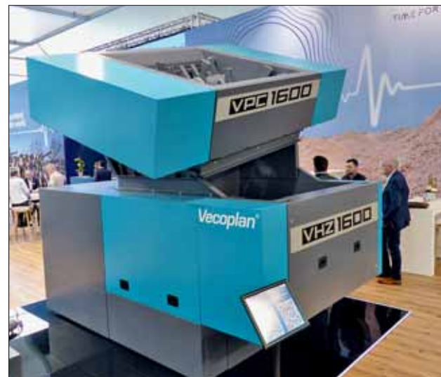
Platzsparende Kombination aus Vorbereiter (oben) und Zerkleinerer: Der „VPC 1600“ wurde für die Messe so aufgesetzt, dass man einen Blick auf die Zerkleinererwerkzeuge hatte.
