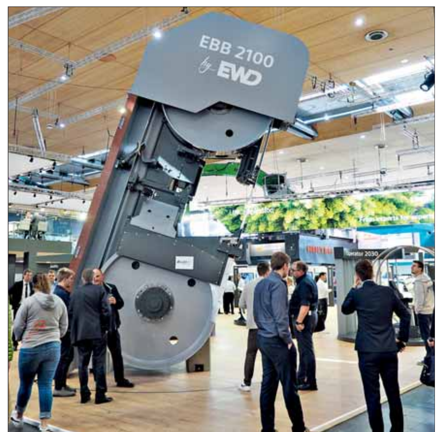
Die Blockbandsäge „EBB 2100“ von Esterer WD (EWD) GmbH, Altötting, mit einem Rollendurchmesser von 2,1 m und rund 27 t Gewicht wird nach der „Ligna“ bei Scierie Moulin im französischen Dunières aufgestellt.
