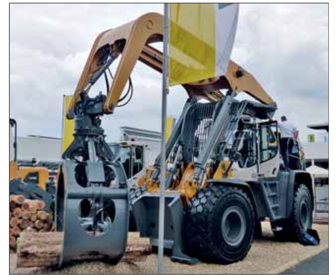
Liebherr zeigte auf der »Ligna« erstmals den Spezialradlader »L 580 Loghandler X-Power« und die Holzumschlagmaschine »LH 26 M Timber Litronic«. Bei dieser wurde auch das Reifendruck-Überwachungssystem vorgeführt, welches Liebherr nun anbietet. Die Sensoren sitzen auf dem Ventil, Abweichungen vom Soll-Druck werden in der Steuerung angezeigt.
