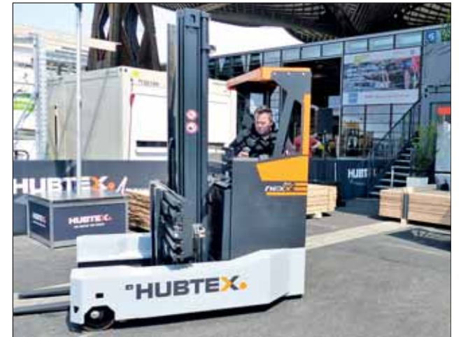
Hubtex demonstrierte in Hannover regelmäßig die Wendigkeit des neuen Mehrwege-Gegengewichtsstaplers „Flux 30“ (nun drei statt vier Räder) und des Mehrwege-Schubmaststaplers „Nexx 30“, beide mit Tragfähigkeiten bis 3 t.
