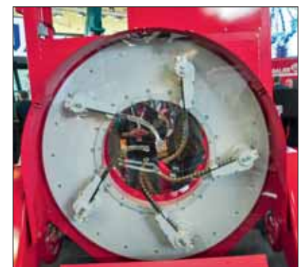
Entrindungsrotor „ZE 905“ von Baljer & Zembrod mit „Variopress“-Verstellsystem
