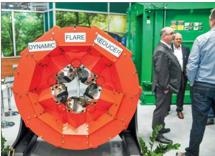
Der „Dynamic Flare Reducer“ von Nicholson ist in die bestehende Entrindung integrierbar.
