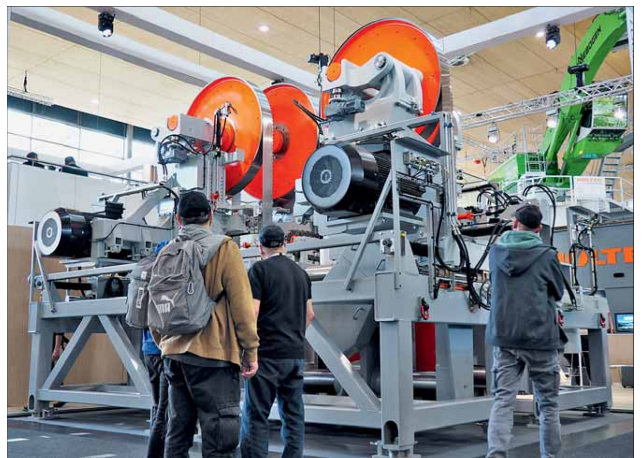
Der „Logmaster HPS“ von USNR läuft mit einer Bandgeschwindigkeit von bis zu 100 m/s und erlaubt eine Vorschubgeschwindigkeit von maximal 180 m/min. Die auf der Messe gezeigte Twin-Ausführung wird bei Ingarp in Schweden zum Einsatz kommen.
