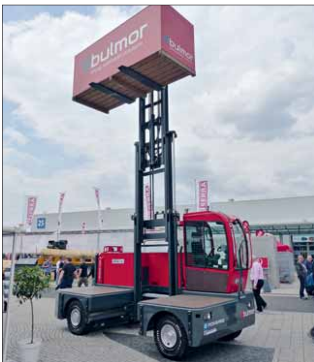
Am »EQ 60« zeigte Bulmor ein weiteres Angebot im Bereich Elektro-Seitenstapler mit Lithium-LFP-Akku-Technik.
