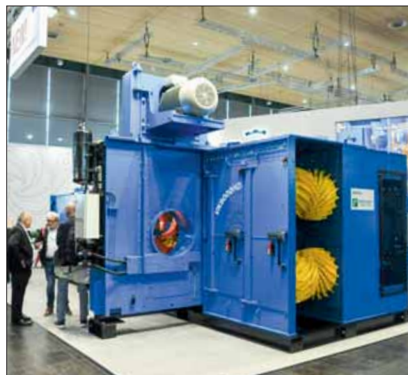
Der finnische Hersteller Valon Kone zeigte einen kompletten Entrinder Modell „VK 9000 HD“. Jede Vorschubwalze verfügt über einen eigenen Elektromotor.
