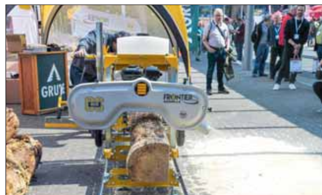
Forstgeräthändler Grube zeigte eine vom amerikanischen Hersteller Norwood geplante und in China unter dem Markennamen „Frontier“ gebaute preisgünstige Lösung für das mobile Sägen.
