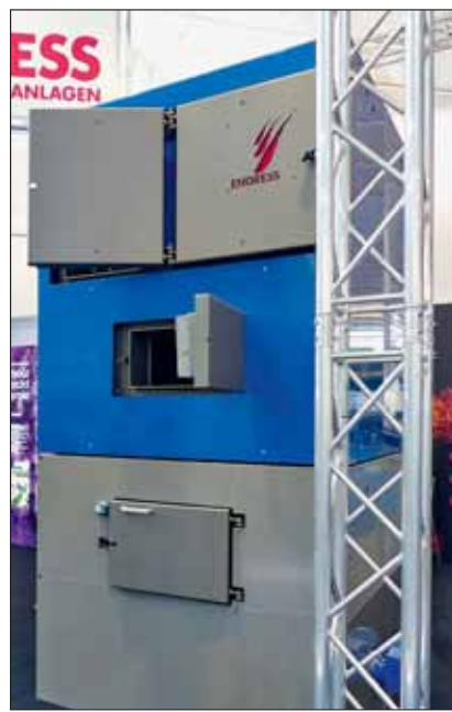
Die Entwicklung bei Endress zielt unter anderem auf das optische Erkennen wechselnder Brennstoffqualitäten.
