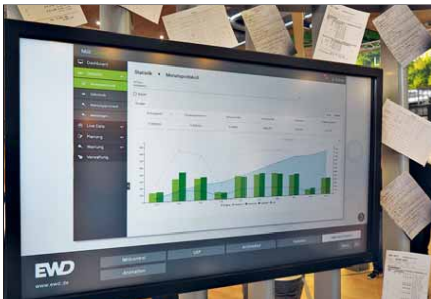
Abschied von der Zettelwirtschaft: Die Applikation „Millcontrol“ von Esterer WD (EWD) GmbH erfasst zum Beispiel Fertigungsdaten und bereitet sie zu Statistiken auf.
