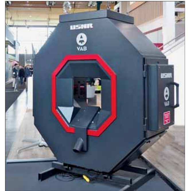
Der „VAB Lineal Grader“ von USNR wurde entwickelt, um gezielt die Ausbeute in den Sortierklassen hoher Qualität zu steigern. Der mit 3D-Kameras und Lasern arbeitende Scanner hat sich auf dem nordamerikanischen Markt bereits etabliert, nun soll der globale Markt erschlossen werden.
