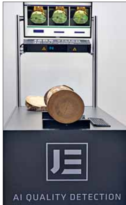
Das System „Joro-Vision“ von Jörg Elektronik GmbH, Oberstaufen, erkennt Stirnflächen mittels künstlicher Intelligenz und erfasst automatisch die Holzmerkmale.
