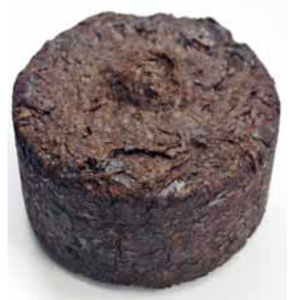
Polytechnik baut gemeinsam mit Andritz an einem Werk in Finnland zur Torrefizierung von Biomasse. Das in seinem Kohlenstoffgehalt gesteigerte Material wird zu Briketts verpresst.
