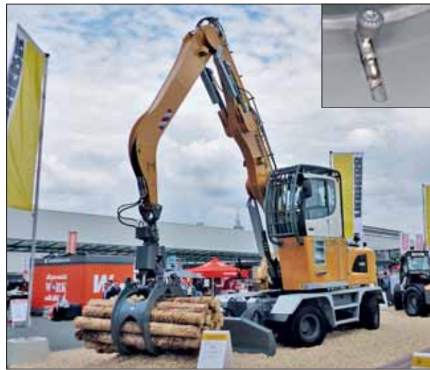
Liebherr zeigte auf der »Ligna« erstmals den Spezialradlader »L 580 Loghandler X-Power« und die Holzumschlagmaschine »LH 26 M Timber Litronic«. Bei dieser wurde auch das Reifendruck-Überwachungssystem vorgeführt, welches Liebherr nun anbietet. Die Sensoren sitzen auf dem Ventil, Abweichungen vom Soll-Druck werden in der Steuerung angezeigt.
