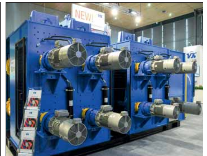
Der finnische Hersteller Valon Kone zeigte einen kompletten Entrinder Modell „VK 9000 HD“. Jede Vorschubwalze verfügt über einen eigenen Elektromotor.
