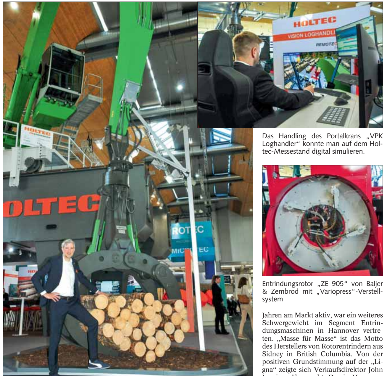
Holtec-Geschäftsführer Alexander Gebele präsentierte den „VPK Loghandler“, eine Kombination aus Portalkran und Rundholzbagger. Vision ist, das Log-Handling von einem Indoor-Arbeitsplatz aus digital zu steuern. Fotos: mh
