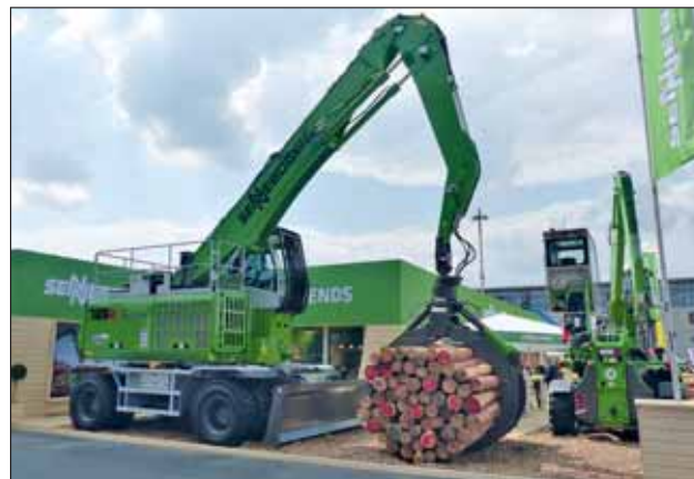
Durch den diesel-elektrischen Antrieb sind beim Umschlagbagger »735 E« im Pick-and-Carry-Einsatz bis zu 30 % Treibstoffersparnis möglich, so Sennebogen.
