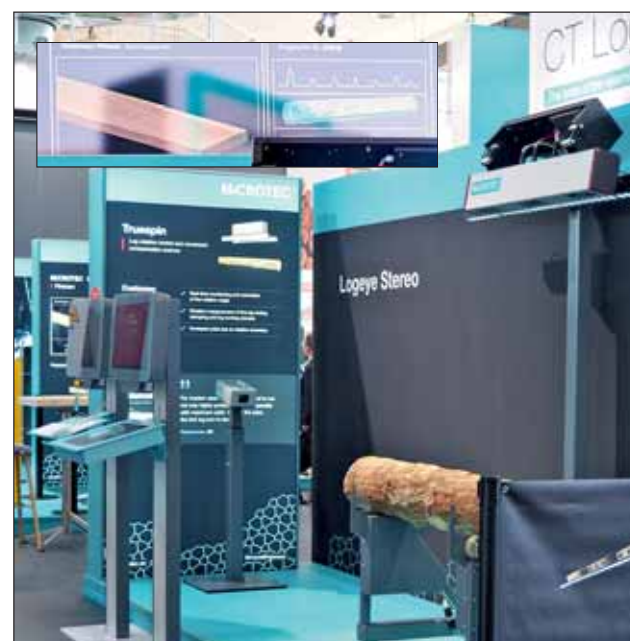
Stereoskopie ist das Messprinzip der patentierten 3D-Vollkonturmessung „Logeye Stereo“ von Microtec, und kommt auch im „Truespin“ zur Überwachung der Stammrotation zum Einsatz.
