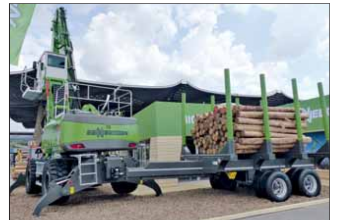
Mit Trailer zu sehen war auch der 43-t-Mobil-Umschlagbagger »830 E«, für den der Hersteller effizientes Arbeiten durch schnelle Transport- und Ladezyklen verspricht.
