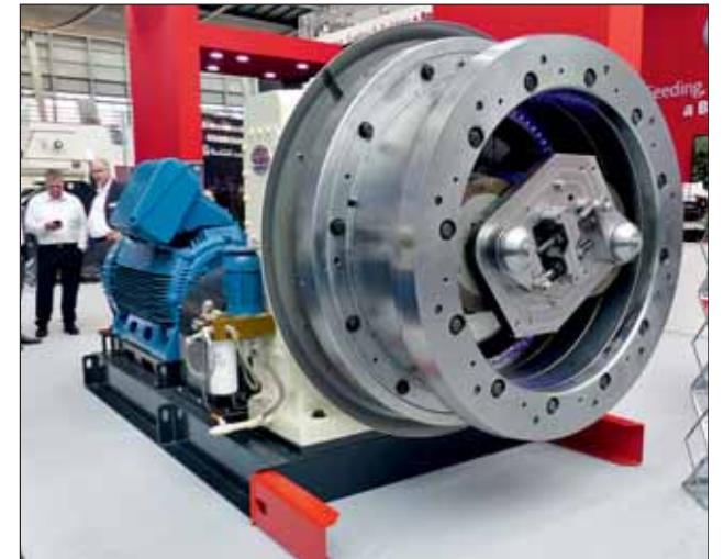
Die neue CPM-Presse (hier der Prototyp) soll bis zu 10 t/h leisten.
