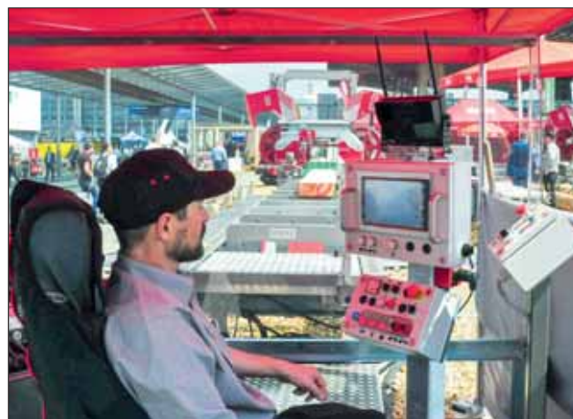
Die Steuerung erfolgt bei der „XE135“ komfortabel von einem Bedienstand aus mit Joystick und über Bildschirm.
