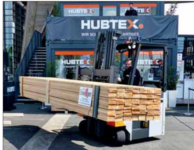
Hubtex demonstrierte in Hannover regelmäßig die Wendigkeit des neuen Mehrwege-Gegengewichtsstaplers „Flux 30“ (nun drei statt vier Räder) und des Mehrwege-Schubmaststaplers „Nexx 30“, beide mit Tragfähigkeiten bis 3 t.
