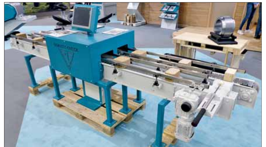
Teil einer Linie zur Erzeugung von Palettenklötzen bei Rudnick und Enners. Sie kann kombiniert werden mit Anlagen zur Brikettherstellung.
