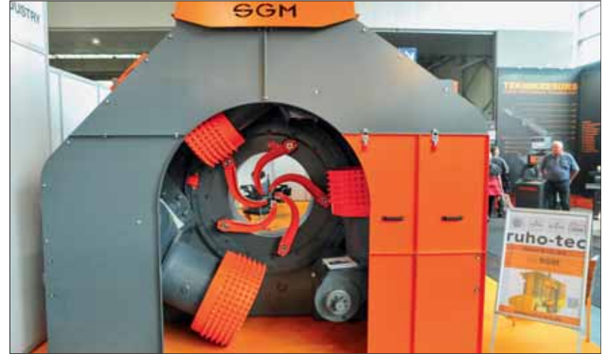
Der französische Hersteller SGM zeigte seine Rotorenrindungsanlagen mit Stammzentrierung. Vertreten wird SGM in Deutschland von der Firma Ruho-Tec.
